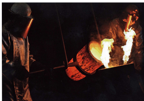
Coulée de cloche au creuset le bronze en fusion MUSÉE PACCARD - photo Yannick Perrin
