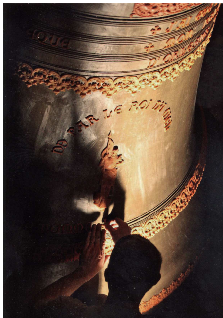
Fabrication de la fausse cloche pose des décors en cire MUSÉE PACCARD photo Yannick Perrin
